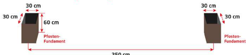
Abb. 1 Die Fundamenttiefe ist eine Mindestangabe und kann regional variieren!
